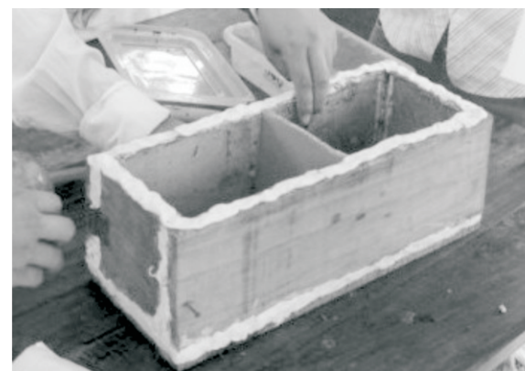
Figura 1. Modelo de caja de tecnología intermedia con bisagras utilizado en el estudio. Se observa la plastilina colocada en los bordes como preparación a la transferencia de la división.
